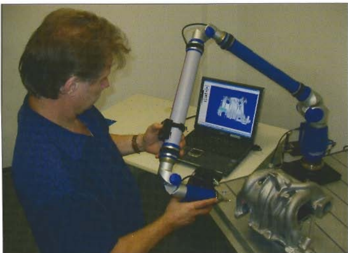
Bild 2: Die Handhabung des Systems ist denkbar einfach: Der Lichtstreifen des Laser-Scanners wird über das Objekt geführt, und auf dem Bildschirm des Notebooks werden die erfassten Flächen in Echtzeit geshadet abgebildet.
