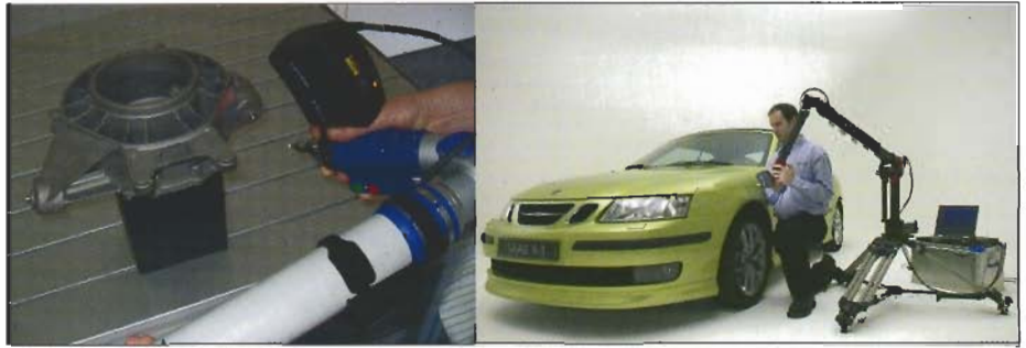
Bild 1: Der kleine und handliche 3D-Scanner ModelMaker Z eignet sich sowohl zum Scannen von Einzelteilen wie dem Turboladergussteil (links), aber auch wegen seiner Mobilität zum Scannen ganzer Baugruppen in Originalgröße wie beispielsweise Automobile (rechts).
